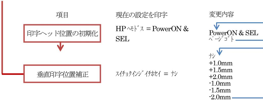
変更が終わったら印刷可 SW と紙送り SW を同時に押します。（どの項目の後でも可）
