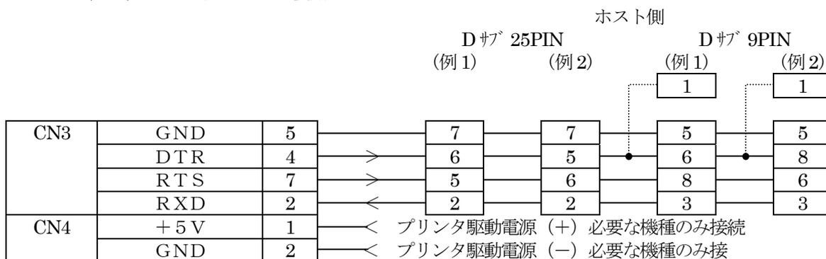
プリンタからのDTRとRTSをホスト側のDSR、CTSに接続する部分が異なります。ホスト側の信号でオープン（未接続）でも動作可能な機種もありますが、上記以外の信号で処理しなければならないものがあれば処理を行ってください。市販のケーブルを御使用の場合は、DOS/V機用クロス、リバース、インターリンクと呼ばれるケーブルを御使用ください。P. E. やERROR等の信号は他のI/Oポートで確認します。
